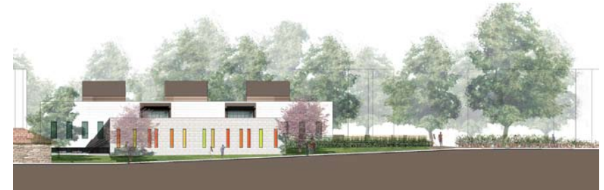
Façade Nord-Est «épaisse», moins d'ouverture et plus de matière pour s'isoler du Nord
